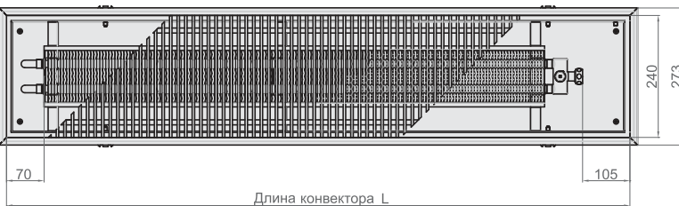
Вид сверху конвектора Ntherm 250.150 с роликовой решеткой, с F-образным бортом.
